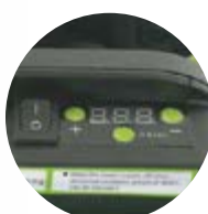
Regulación de la presión del nudo (1-10)
