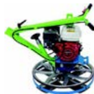
Manillar plegable para facilitar el transporte y el almacenaje
